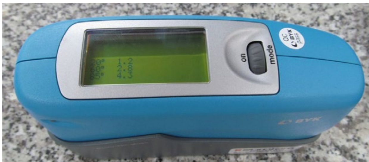
Połyskomierz - urządzenie do pomiaru połysku
